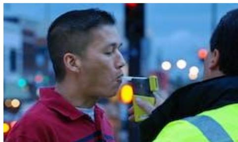
L'éthylotest, utilisé pour la sécurité routière, mesure le taux d'éthanol dans l'air expiré.
